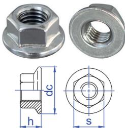
**DIN 6923 - Sechskantmuttern mit Flansch**
